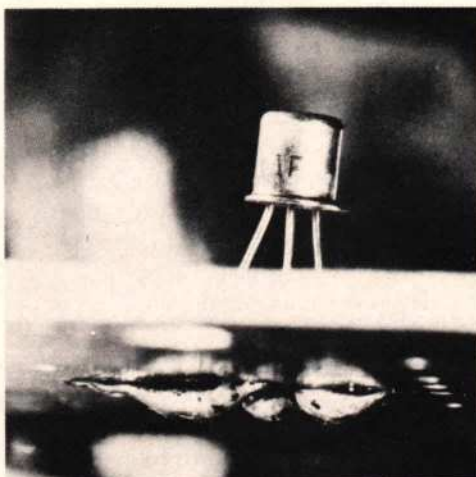
Afb. 22: Het solderen van de transistor is klaar. Mochten in een schakeling aansluitdraden heel dicht bij elkaar liggen, dan kan men ze zekerheidshalve van isolatiekous voorzien om kortsluitingen te vermijden. Meestal is zo'n voorzorgsmaatregel echter niet nodig.
